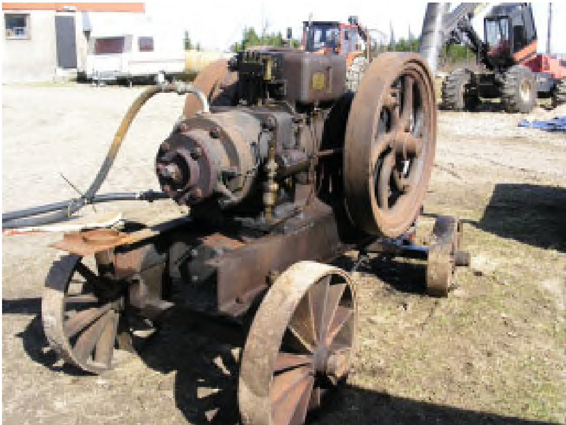
Torps Bruks motor på 25 hk s.k. semidiesel där tändkulan ersatts med en okyld plugg i topplocket
