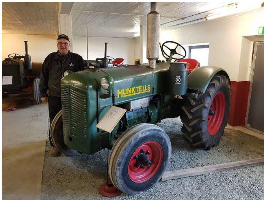
BM 20 hos Dalslands Traktormuseum Motorn hade sidinsprutning och var på 41 hk som tillverkades mellan 1945 och 1950
