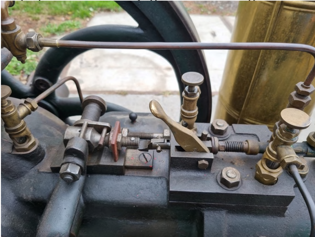
Fig. 132. Oljetillförsel till kolvtappslagret. A. E. G.-tändkulemotor.
