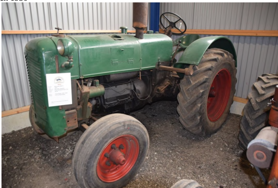
Traktorn tillverkades även som BM 21. Motorn hade toppinsprutning och var på 46 Hk som tillverkades mellan 1951–1952.
