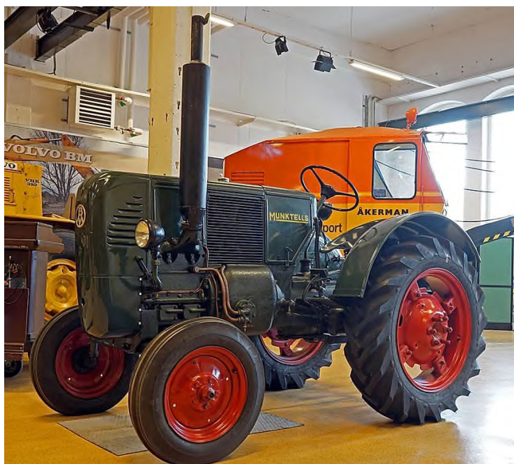
Detta var Munktells sista modell BM 10 med en 2 cylindrig mer snabbgående motor på 1000 varv/minut.
