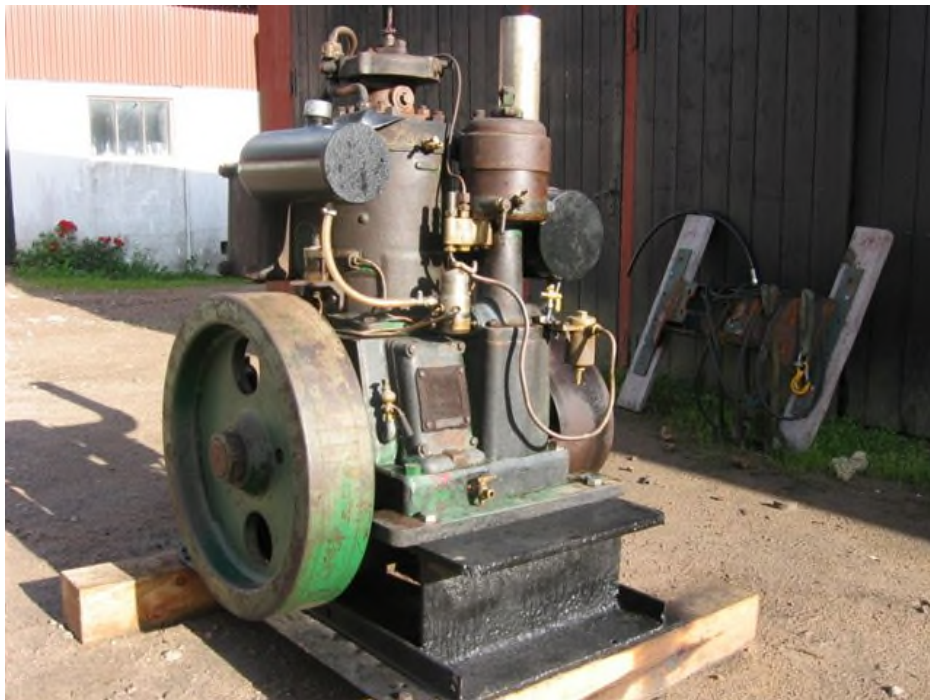
Bolinder W7 på 25 hk 1940. Tillverkades med upp till 4 cylindrar. Var vanlig i fiskebåtar och bogserbåtar.
